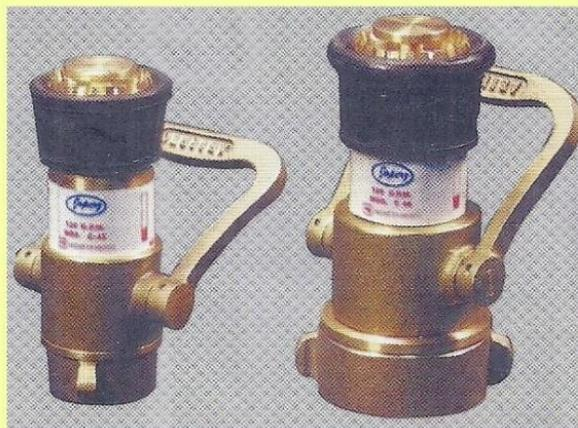
BOQUILLAS CON VALVULA DE PASO DE APERTURA Y CIERRE RAPIDO REGULADORAS DE CHORRO DE AGUA FRABRICADAS EN BRONCE , LLEVA UN CAPUCHON EN LA PARTE SUPERIOR PARA PROTECCION CONTRA GOLPES, UTILIZADAS PARA MANGUERAS CONTRA INCENDIO Y SE FABRICAN DE 1 1/2 Y 2 1/2 Y PUEDE SER CUERDA IPT O NST .
