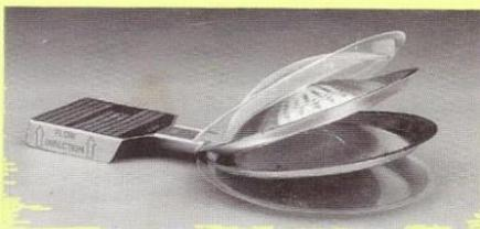
El disco de ruptura LPLV es como el disco de ruptura LPL, pero además es capaz de soportar un vacío total. Este disco de ruptura generalmente se compone de un forro de salida de Teflon, un soporte metálico de vacío, una sección superior metálica y un sello de Teflon en el lado del proceso de la sección superior. La colocación de Teflon en los lados de entrada y de salida ayuda a proteger el soporte de vacío y la sección superior contra los agentes corrosivos y reduce la acumulación de productos.
