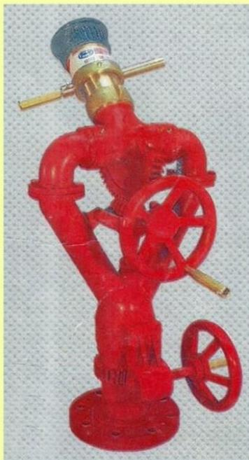
**MONITOR ESTACIONARIO TIPO CORAZON DE DOBLE CREMALLERA FABRICADO EN BRONCE FUNDIDO OPERA DOS TIPOS DE MOVIMIENTO: GIRO VERTICAL DE 120 GRADOS ACCIONADO POR MANIVELA Y GIRO HORIZONTAL DE 360 GRADOS FIJADO MEDIANTE FRENO MANUAL , SU ENTRADA ES BASE BRIDADA DE 4" CARA REALZADA Y LLEVA UNA SALIDA DE 2 1/2 MACHO ROSCA NST PARA INSTALAR LA ROSQUILLA REGULADORA CON UNA PRESION MINIMA DE 225 psi Y UNA PRESION MAXIMA DE 500 psi UNA PRESION DE TRABAJO DE 100 psi .**
