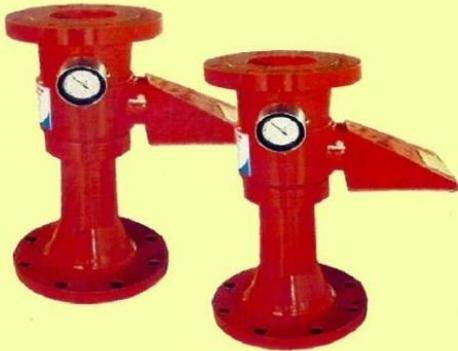
Fabricados en aluminio SAE 356 y/o A613. Utilizados para proporcionar espuma en tanques de techo flotante desde la parte inferior. Manómetro incluido, para la medición precisa del volumen. Alta protección y acabado en "rojo seguridad" resistente a ambientes marinos.
