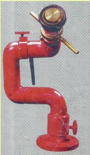
MONITOR TIPO DE CUELLO DE CISNE O GANSCO FABRICADO EN BRONCE , OPERA DOS TIPOS DE MOVIMIENTOS GIRO VERTICAL DE 120 GRADOS ACCIONADOS POR PALANCA Y GIRO HORIZONTAL DE 360 GRADOS FIJADOS POR FRENO MANUAL CON BASE BRIDADA DE 4" CARA REALZADA Y SU SALIDA ES DE 2 1/2 MACHO ROSCA NST Y PARA ADAPTARSE A BOQUILLAS REGULADORAS DE CHORRO DE AGUA.
