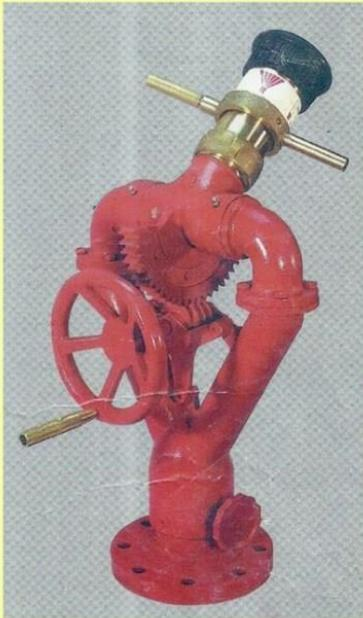
**MONITOR ESTACIONARIO TIPO CORAZON DE UNA CREMALLERA FABRICADO EN BRONCE FUNDIDO OPERA DOS TIPOS DE MOVIMIENTO: GIRO VERTICAL DE 120 GRADOS ACCIONADO POR MANIVELA Y GIRO HORIZONTAL DE 360 GRADOS FIJADO MEDIANTE FRENO MANUAL , SU ENTRADA ES BASE BRIDADA DE 4" CARA REALZADA Y LLEVA UNA SALIDA DE 2 1/2 MACHO ROSCA NST PARA INSTALAR LA ROSQUILLA REGULADORA CON UNA PRESION MINIMA DE 225 psi Y UNA PRESION MAXIMA DE 500 psi UNA PRESION DE TRABAJO DE 100 psi .**
