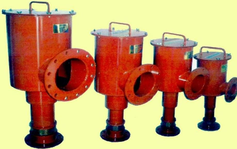
Fabricadas en acero al carbón. Consisten de una cámara de expansión de espuma y un formador de espuma integral. Cuentan con deflector sólido o dividido, una placa de orificio en acero inoxidable 304, sello de vapor de vidrio calibrado al espesor debido y asientos de hule. Protección y acabado en rojo "seguridad" resistente a ambientes marinos.
