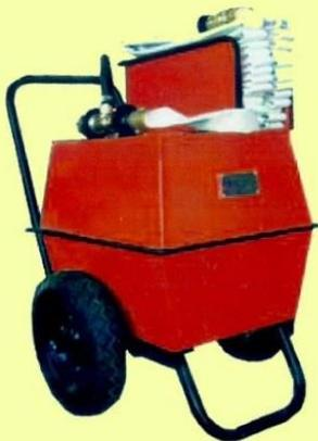
CARROS PARA ESPUMA DE 36 GALONES . FABRICADOS EN FIBRA DE VIDRIO , POSEE UN EDUCTOR EN LINEA DE 125 gpm , UNA MANGUERA DE 1 1/2 X 30 MTS. DE LARGO Y UN CHIFLON DE NIEBLA DE 80 gpm . LA FACIL MOVILIDAD Y MANEJO DE LOS CARROS DE ESPUMA LOS CONVERTEN EN UNIDADES ALTAMENTE EFECTIVAS PARA COMBATIR INCENDIOS DE LIQUIDOS INFLAMABLES.
