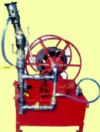
UNIDADES AUTO-CONTENIDAS , DISEÑADAS PARA CONECTARSE A UNA FUENTE DE AGUA PRESURIZADA EN UNA LOCACION FIJA. CAPACES DE MANEJAR 60 GAL. DE CONCENTRADO DE ESPUMA , INCLUYE MINIMONITOR , MINICHIFLON HYDROFOAM , EDUCTOR Y MANGUERA CON CHIFLON. EL MINI MONITOR Y LA MANGUERA PUEDE UTILIZARSE POR SEPARADO O SIMULTANEAMENTE CON AGUA O ESPUMA.
